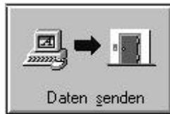
Mit diesem Befehl senden Sie die in der Software gemachten Einstellungen von Computer an den Speicher der Zutritts-Steuerungen.
