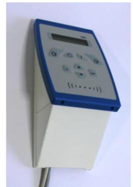
Frontbaugruppe elektrisch verbinden, einhängen und von unten anschrauben
