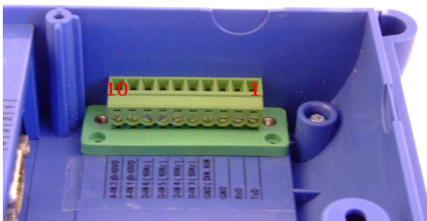
Abbildung 7: Anschlussklemme für digital IN 3-6, analogen IN 1-2 und COM2
